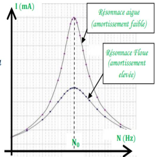
La résonnance d'intensité d'un circuit RLC série peut être accompagnée d'une surtension aux bornes du condensateur, caractérisée par un quotient  $Q > 1$  appelé dans ces conditions facteur de surtension:
